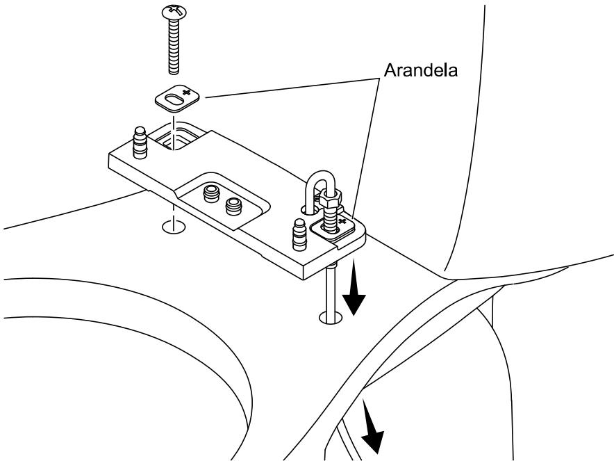
**¡IMPORTANTE!** En inodoros en los que los orificios de montaje del asiento no quedan accesibles por la cara inferior de la taza, use el kit 1362736 y consulte la sección "Instale la placa de montaje (kit 1362736)".
