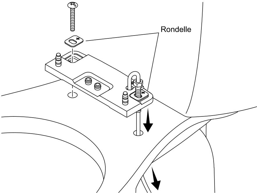
**IMPORTANT!** Pour les toilettes sur lesquelles il n'est pas possible d'accéder aux trous de fixation à partir du dessous de la cuvette, utiliser la trousse 1362736 et se reporter à la section « Installer la plaque de fixation » (trousse 1362736).
