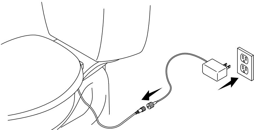
**AVERTISSEMENT : Risque de choc électrique, d'incendie, ou de blessures corporelles.** Connecter uniquement à un circuit nominal de 120 V c.a., 60 Hz protégé par un disjoncteur de fuite de terre (GFCI)\* de 15 A minimum.
