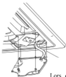
Lors de l'installation du couvercle, faites glisser les quatre fermetures à glissière dans les fentes correspondantes du panneau.
